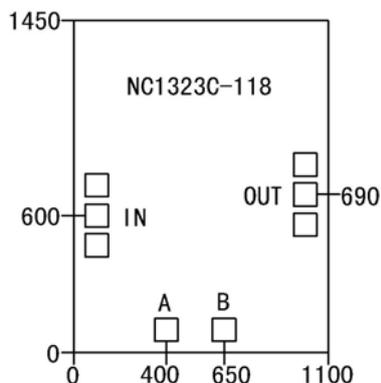
注：所有尺寸单位为微米 ( $\mu\text{m}$ )；所有压点尺寸  $100\times 100\mu\text{m}^2$ 。
